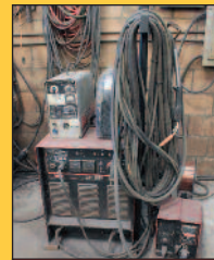
Lincoln Mig Welder
